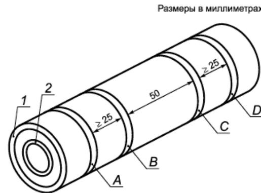
1 - экран по изоляции; 2 - экран по жиле;  $A, D$  - электроды тока;  $B, C$  - электроды напряжения
