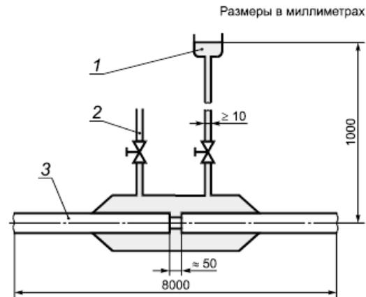
1 - резервуар с водой; 2 - вентиляционное отверстие; 3 - кабель
