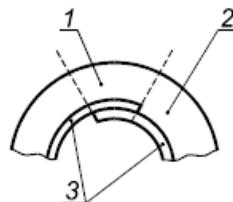
1 - образец; 2 - наружная оболочка; 3 - металлическая фольга или ламинированная металлическая фольга
