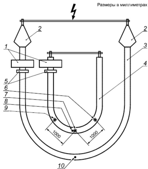
1 - трансформаторы, дающие ток; 2 - концевые муфты; 3 - испытуемый кабель; 4 - стандартный кабель ( $\geq 5$  м); 5 - измерительные трансформаторы; 6 - ТС<sub>3с</sub> (токопроводящая жила); 7 - ТС<sub>1с</sub> (токопроводящая жила); 8 - ТС<sub>1с</sub> (оболочка); 9 - ТС<sub>2с</sub> (токопроводящая жила); 10 - ТС<sub>с</sub> (оболочка)
