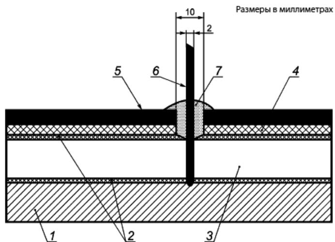
1 - токопроводящая жила; 2 - электропроводящие экраны; 3 - изоляция; 4 - металлическая оболочка; 5 - наружная оболочка кабеля; 6 - термопара; 7 - эластичный теплоизолирующий компаунд
