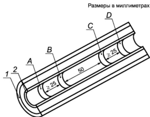
1 - экран по изоляции; 2 - экран по жиле; *A, D* - электроды тока; *B, C* - электроды напряжения
